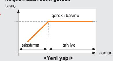
Yüklerde açılıp kapanan yeni iki yardımcı portla donatılmış yeni yapı, çok portlu kompresör, kısmi yük çalışması sırasında soğutucu akışkanı alt porttan tahlİYE eder.
