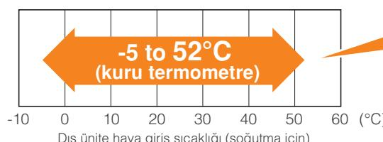
52°C'ye kadar sıcaklıklarda çalışabilir
